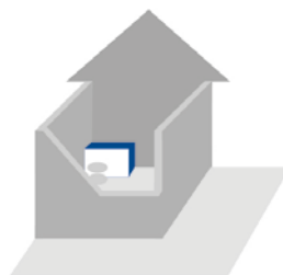
PAC placée dans une cour intérieure +9 dB(A)
