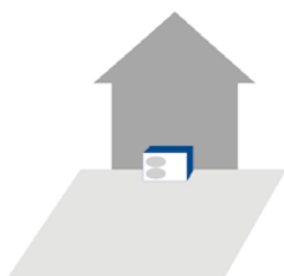
PAC placée contre un mur +3 dB(A)
