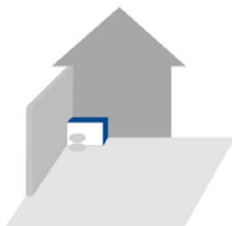
PAC placée dans un coin +6 dB(A)
